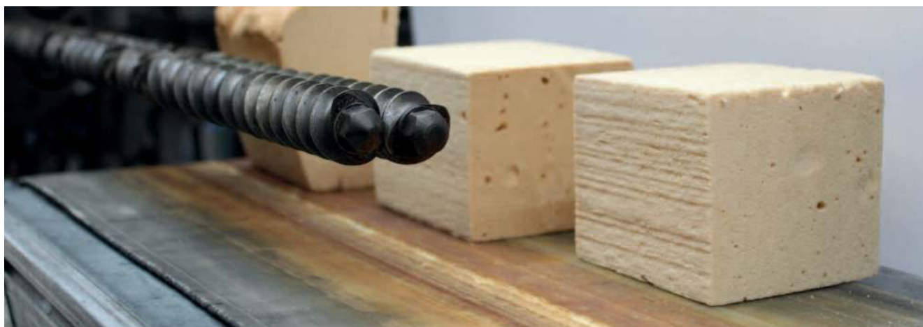
Ein Doppelschneckenextruder an Stelle der üblichen Mischköpfe könnte die mechanische Wiederverwertung von Polyurethan-Hartschaum revolutionieren
