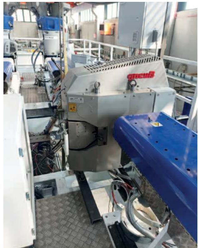
RSF genius -Filter-system in Betrieb im Technikum von Colines
