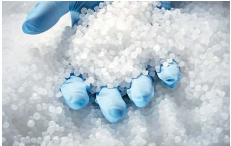
Die Anforderungen an die Reinheit von XLPE-Granulat sind besonders hoch
